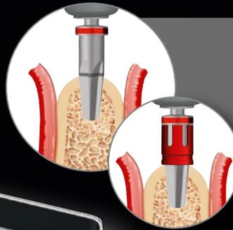
Vor Kopf schneidende, formkongruente Bohrer – wahlweise mit oder ohne Bohrstop anwendbar
